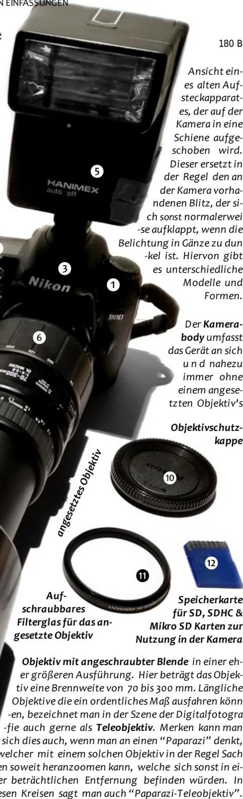
Ansicht eines alten Aufsteckapparates, der auf der Kamera in eine Schiene aufgeschoben wird. Dieser ersetzt in der Regel den an der Kamera vorhandenen Blitz, der sich sonst normalerweise aufklappt, wenn die Belichtung in Gänze zu dunkel ist. Hiervon gibt es unterschiedliche Modelle und Formen.
